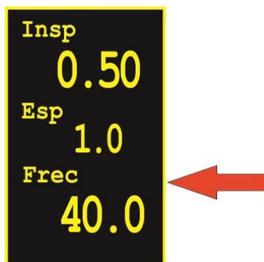
Fig. 75: Versión con frecuencia de respiración configurable
