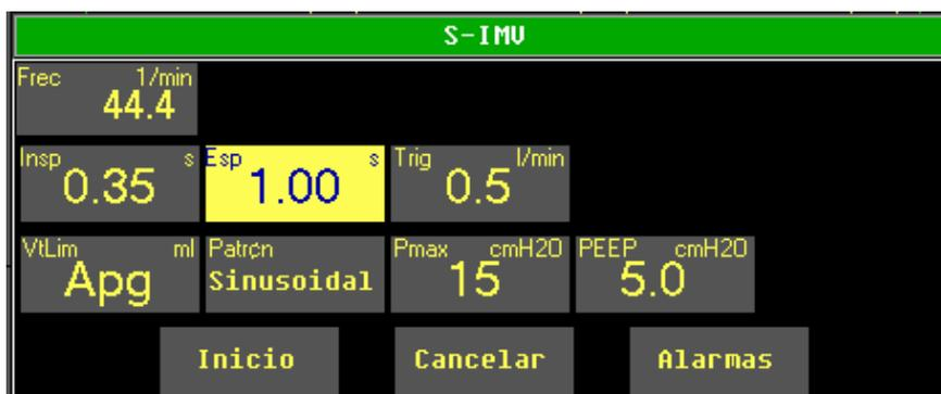
Fig. 61: Menú emergente de configuración del tiempo de espiración
