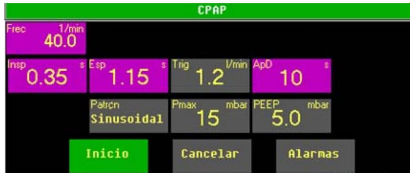
Fig. 98: Configuración de parámetros de CPAP (con ventilación de backup controlada por frecuencia)
