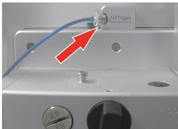
Fig. 113: Conexión del sensor de respiración externo
