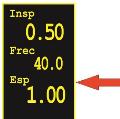
Fig. 74: Versión con tiempo de espiración configurable
