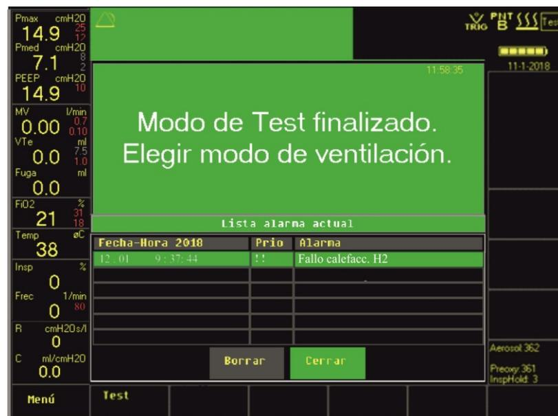
Fig. 73: Modo de Test finalizado, las alarmas generadas se muestran automáticamente
