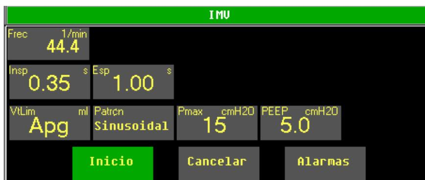
Fig. 77: Configuración de parámetros de IMV
