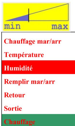
Fig. 46 : Réglage de l'humidité à l'aide du curseur
