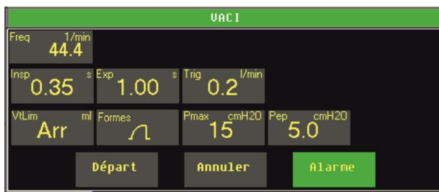
Fig. 63 : Sélection de la zone « Alarme »
