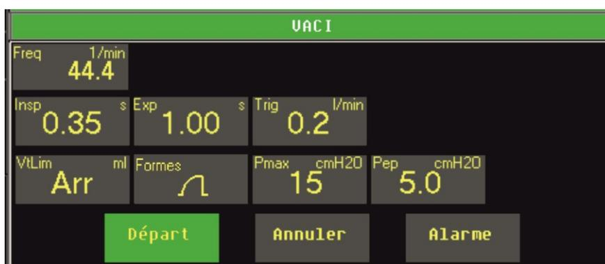
Fig. 62 : Démarrage de la ventilation
