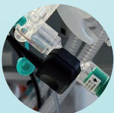
+ Capteur de débit électronique chauffé
