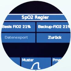
+ El regulador de SpO<sub>2</sub> SPO<sub>2</sub>C garantiza una saturación de oxígeno óptima
